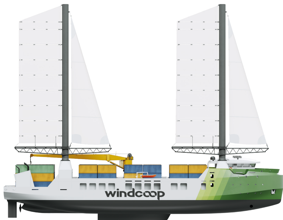
Une esquisse du premier porte-conteneurs à la voile de Windcoop, propulsé en grande majorité par l'énergie du vent.
